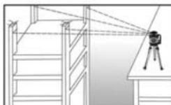
Repère pour l'installation d'un plancher de ciment
